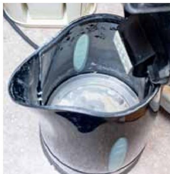
Depósito sólido de carbonato de calcio ( \text{CaCO}_3 ) adherido a la superficie interna de un hervidor eléctrico, conocida como «sarro».
